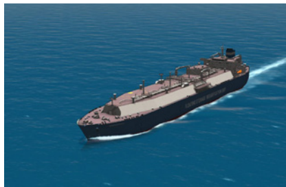
DUAL FUEL DIESEL-ELECTRIC LNG CARRIER
